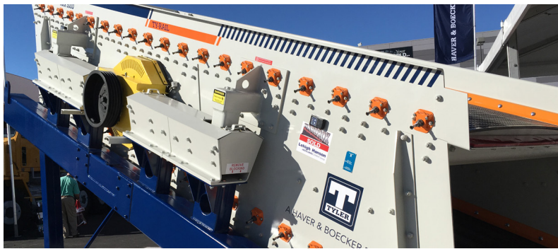
Écrous autofreinés installés sur table vibrantes
